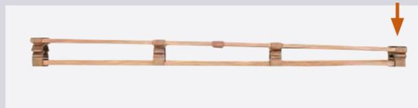
Die Federschiene ist durch die Kautschukelemente elastisch bis zum Rand. Anders als bei herkömmlichen Lattenrosten ist der elastische Kautschuk – und nicht die Holzleisten – für den größeren Teil des Federweges verantwortlich.
