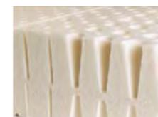
Die konische Form der Öffnungen bewirkt, dass die Festigkeit der Matratze zunimmt, je tiefer der Körper einsinkt. Denn in tieferen Schichten leistet im Verhältnis mehr Latexmasse dem Körpergewicht Widerstand. Folge: Menschen mit unterschiedlichem Körpergewicht liegen auf der Matratze gleich gut.
